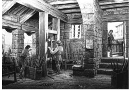
Diorama d'un tornall de barrinar canons (Imatge: Museu Etnogràfic de Ripoll) (Mides reals: 0,97 m d'ample, 0,60 m d'alt i 0,70 m de profunditat)
